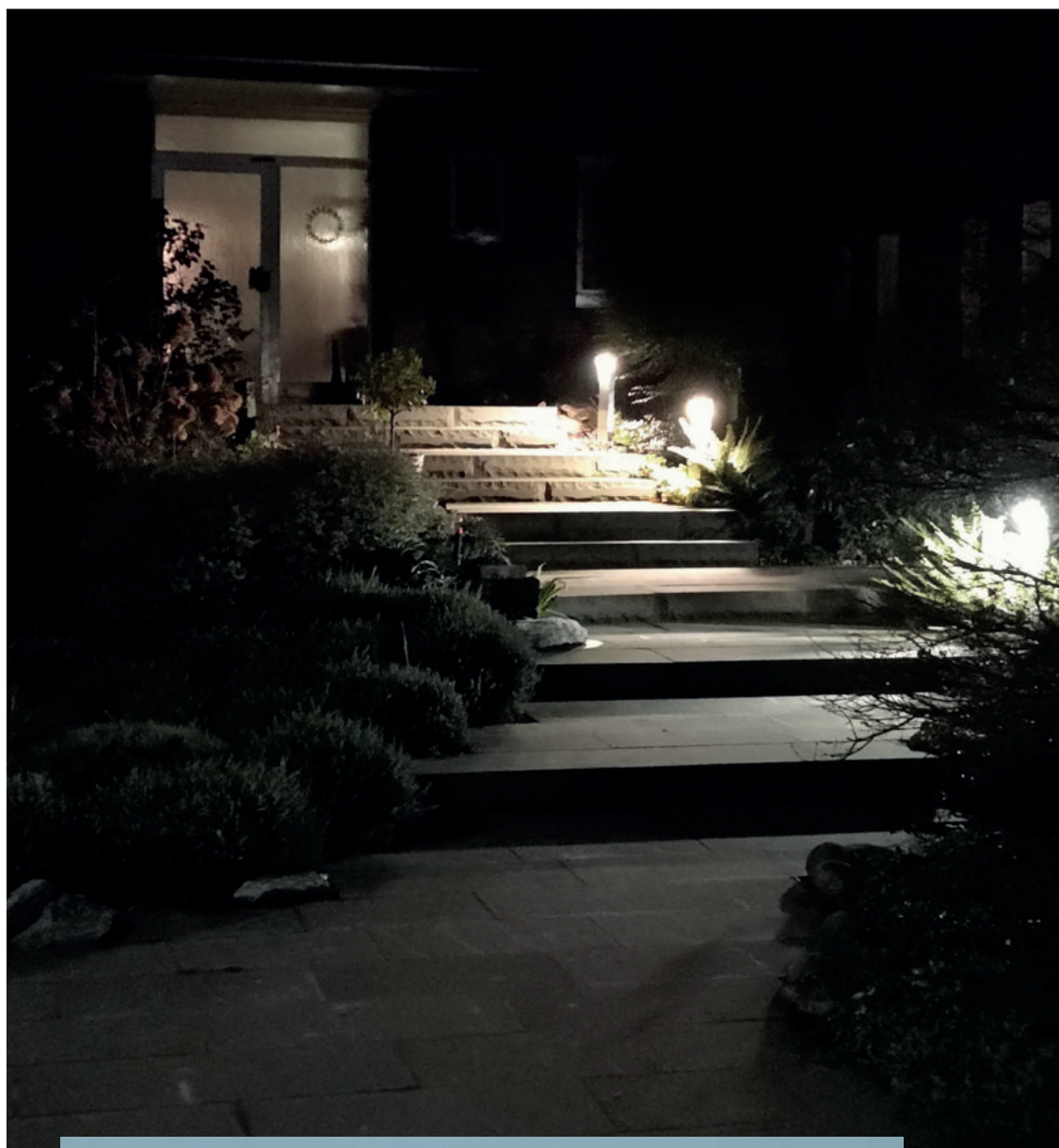
Es lohnt, gleich beim Wegebau eine indirekte und blendfreie Beleuchtung vorzusehen, die Lichtquellen geben Orientierung bei Dunkelheit.
